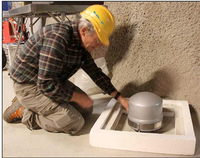
Fig. 5): Installation of the seismometer STS2.5
